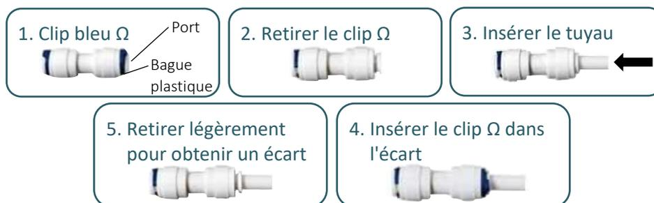
**Pour déconnecter :** Enlever le clip  $\Omega$ , pousser l'anneau plastique contre le raccord pour libérer le tuyau. Sortez le tuyau du raccord.
